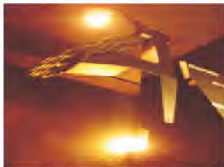
配光曲線量測設備
